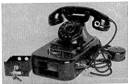
Bild 155. Teilnehmer-Münzfernsprecher 55 Kassette herausgenommen
